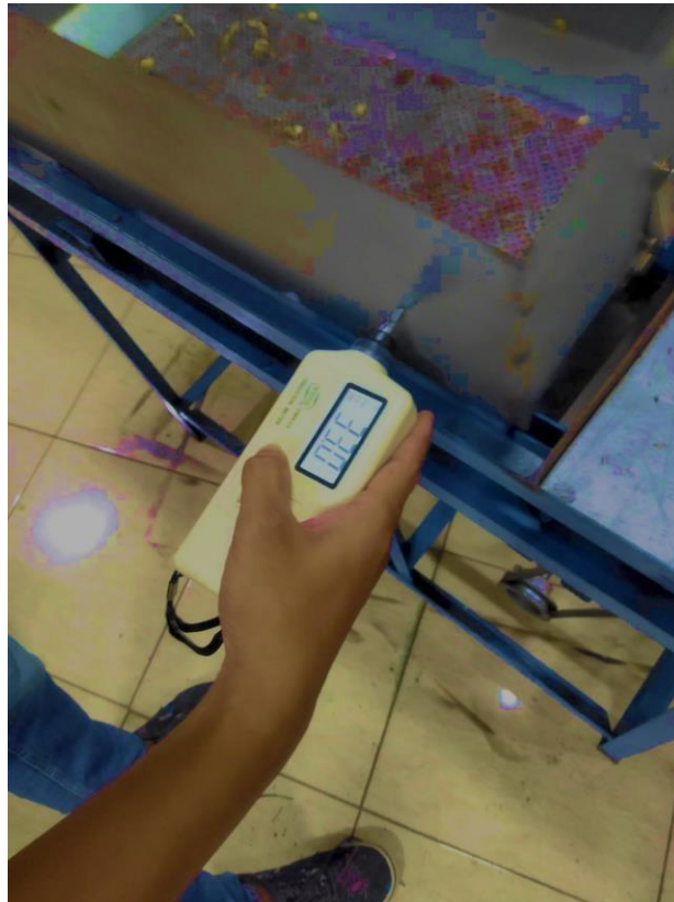
Gambar 3. Pengukuran Getaran Pada Mesin Vibrator Kedelai
