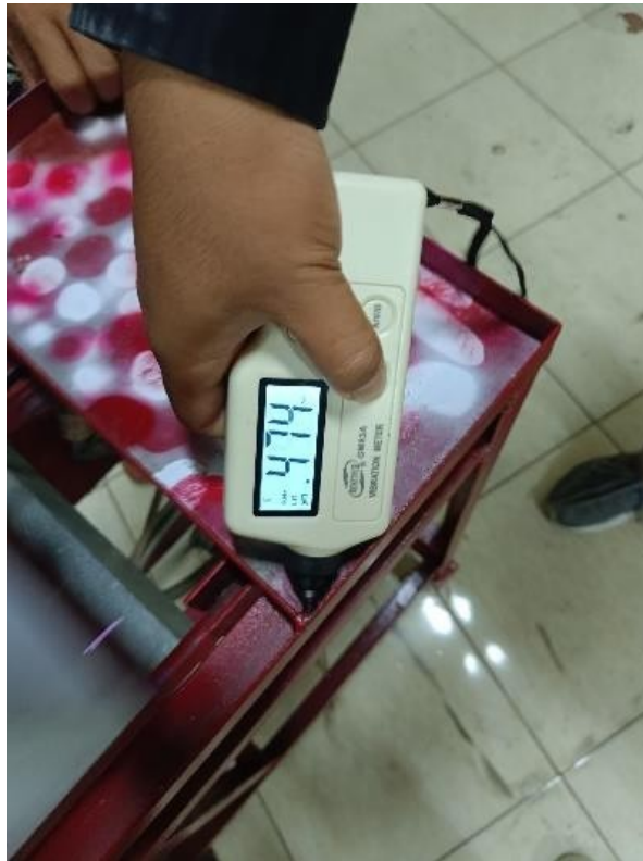
Pengukuran Axial Titik Drive End ( Displacement )
