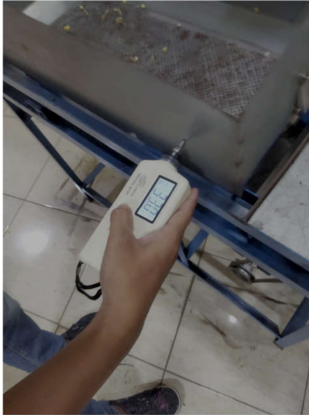
Gambar 3. Pengukuran Getaran Pada Mesin Vibrator Kedelai
