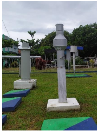
Gambar 8. Foto Alat Penangkar Curah Hujan di Lapangan Pengamatan
