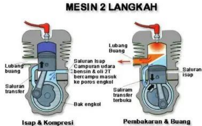
Gambar 2. 1 Mesin Dua Langkah (2-Tak)
