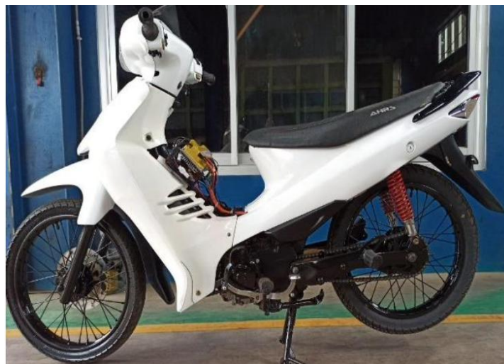
Gambar 3. Hasil penelitian konversi motor manual menjadi motor listrik
