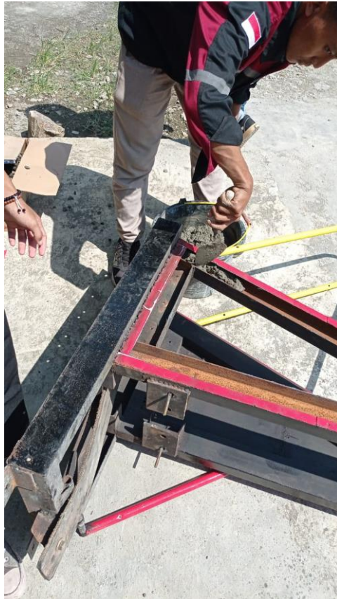
Proses cor pada bagian rangka
