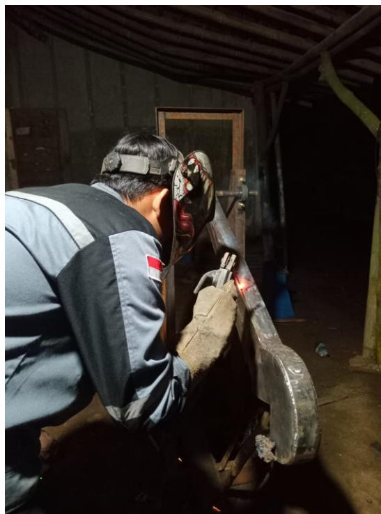
Proses pengelasan pada bagian pendulum
