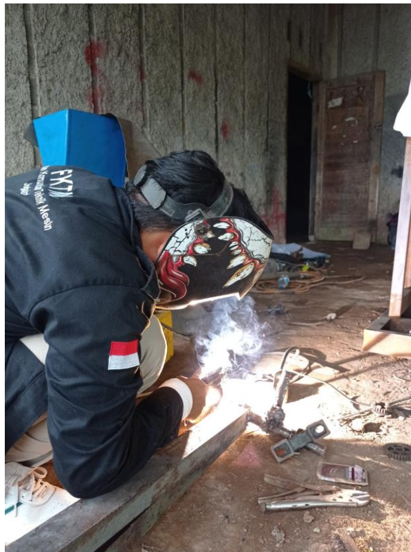
Proses pengelasan pada bagian pendulum
