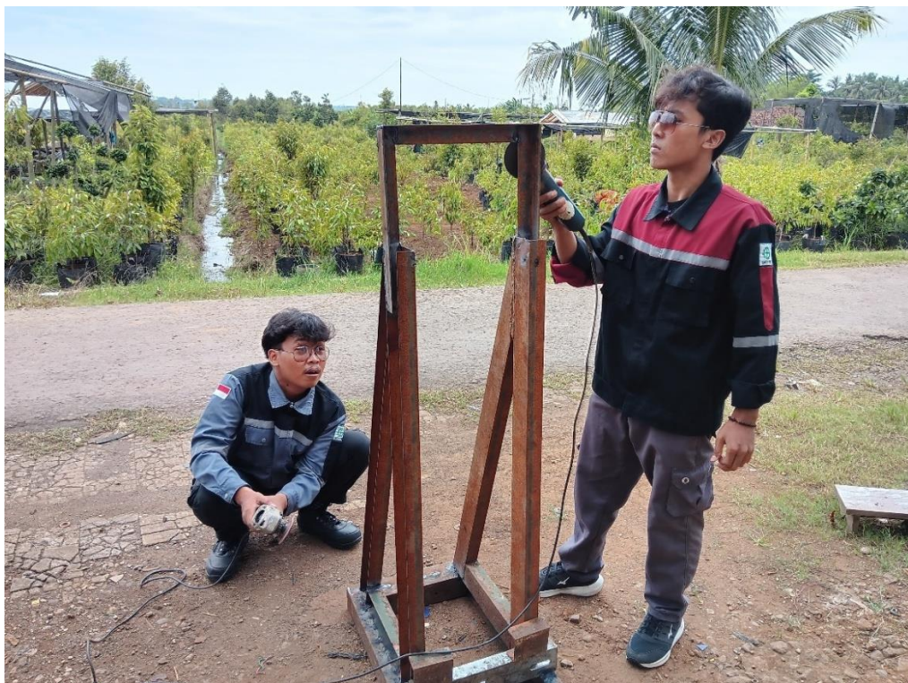
Proses penghalusan pada rangka
