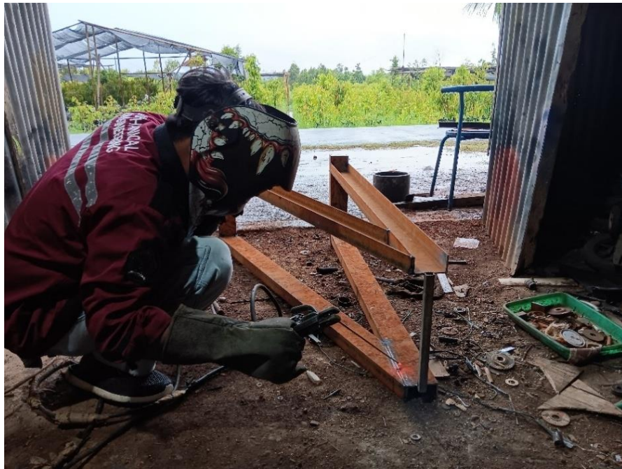
Proses pengelasan pada rangka
