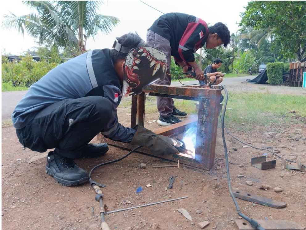
Proses pengelasan pada bagian bawah rangka
