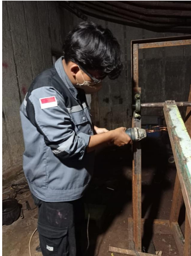
Proses Proses penghalusan pada rangka
