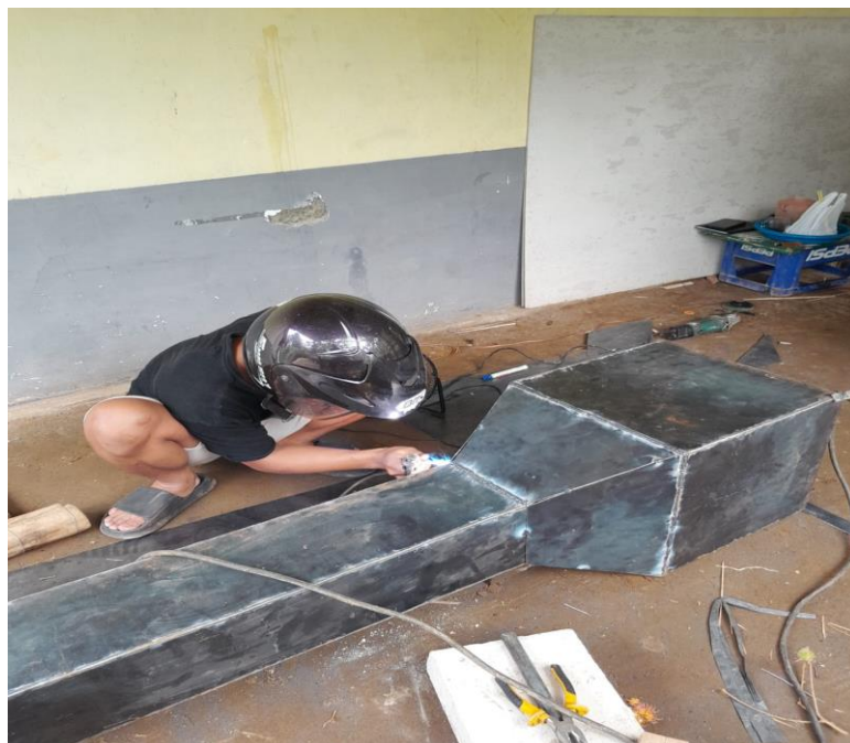
Proses penyambungan pipa persegi/inlet dengan rumah blower/outlet
