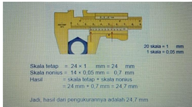
Gambar 2. Pembacaan Skala Jangka Sorong
