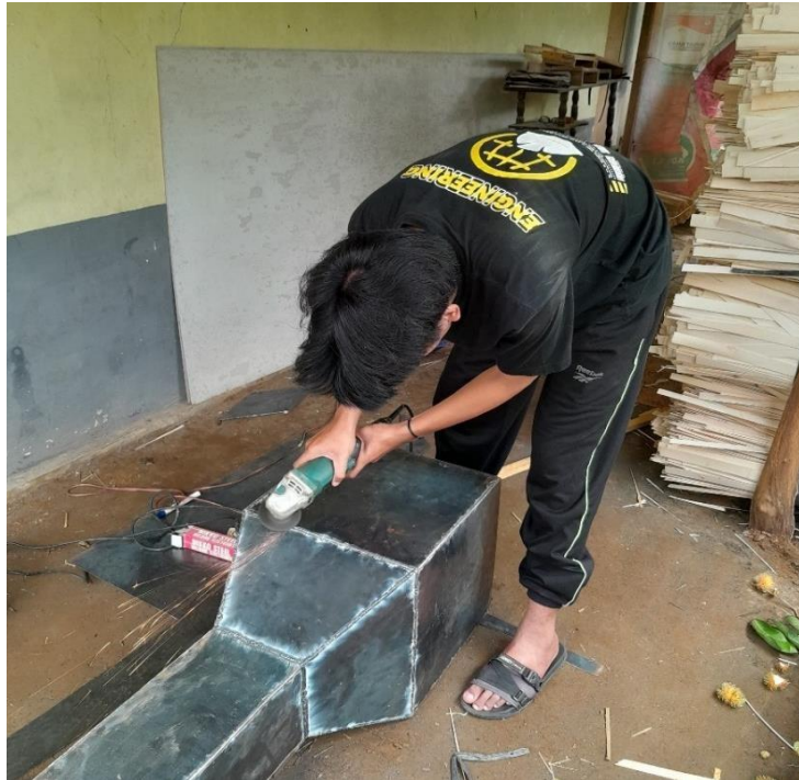
Lampiran 3. Proses Pengamplasan Setelah di Las Menggunakan Gerinda Tangan
