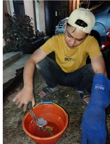
Foto proses pendinginan menggunakan Oli SAE 40.
