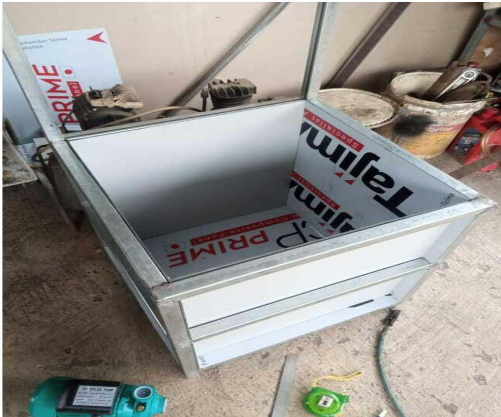
Lampiran 3 Proses pemasangan apc ke kerangka
