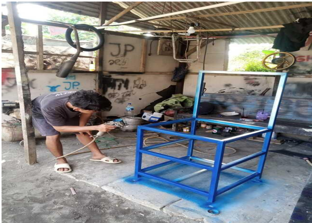
Lampiran 4 Proses pengecatan kerangka alat
