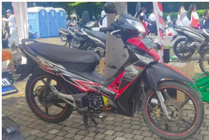
Gambar 1. Motor bebek listrik konversi (Roda2makassar, 2022)
