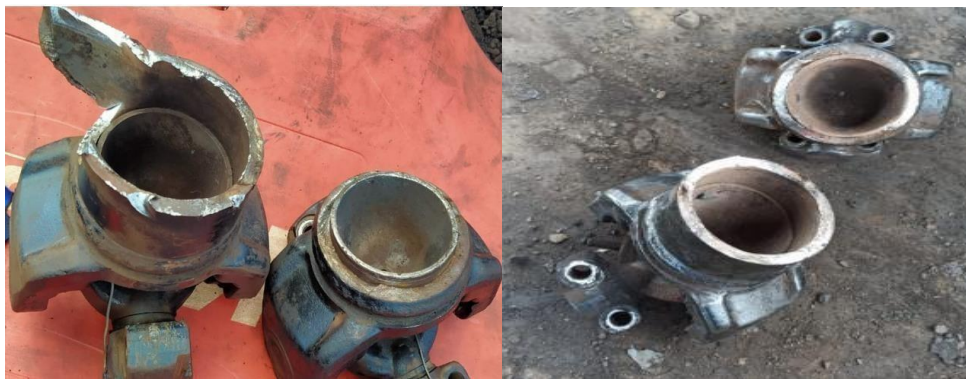
Gambar 2.9. Kegagalan /Patahan pada shaft universal joint
