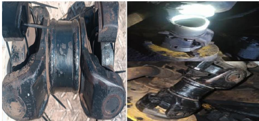
Lampiran 2 : Gambar shaft yang sudah mengalami retakan
