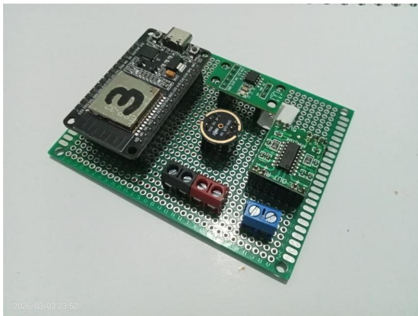
Gambar ini adalah bentuk fisik node yang sudah terrangkai menggunakan PCB lubang.
