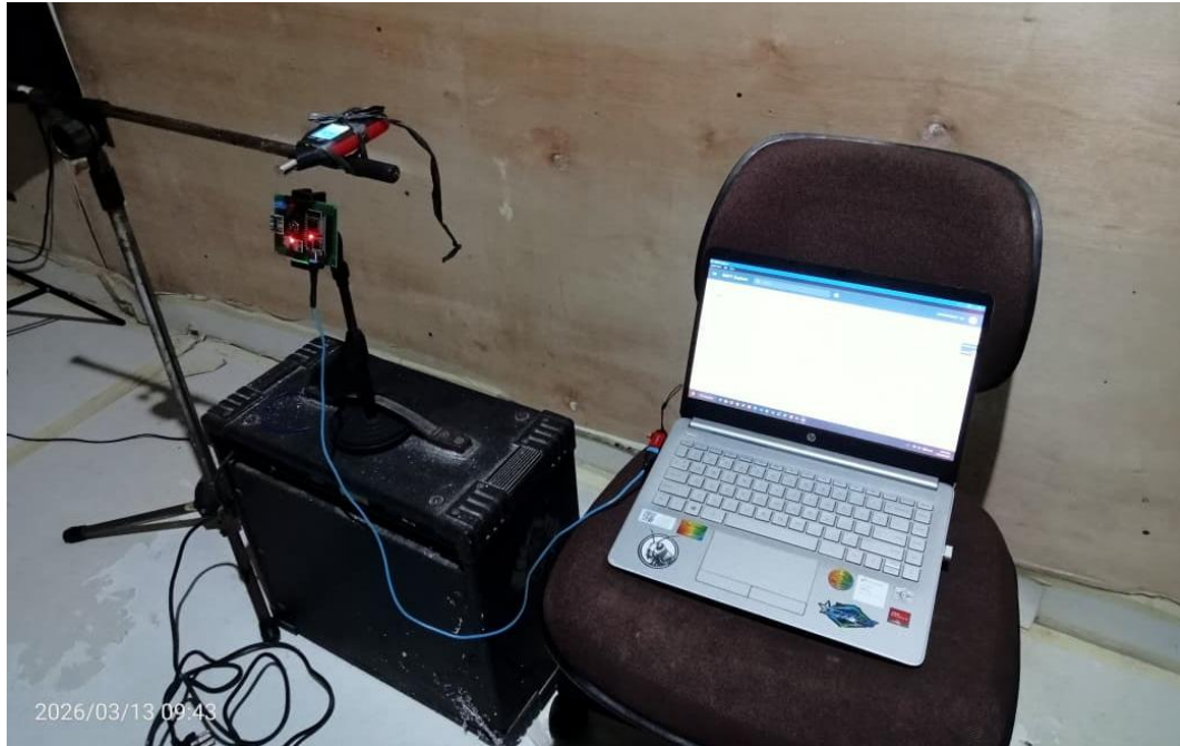
Foto di atas adalah dokumentasi proses kalibrasi node menggunakan SLM di ruangan rekaman shatomeia
